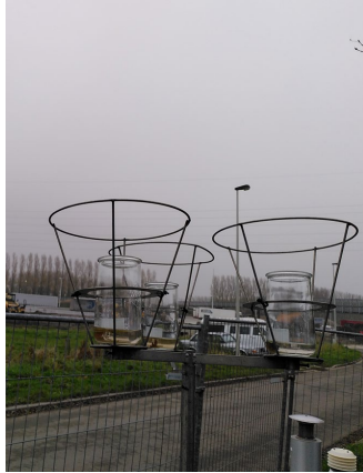
Figuur 3: Opstelling met drie Bergerhoff-neerslagkruiken in een houder met vogelscherm op paal.
