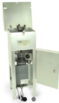
Figuur 1: Foto van de fijnstofbemonsteraar (open). Omgevingslucht wordt via de bemonsteringskop bovenaan aangezogen, door een filter en PUF.
